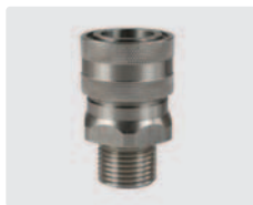
Kupplung : AG. Edelstahl. 60° Dichtkonus. Max. 250 bar / 150 °C
