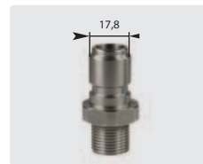
Stecknippel : AG. Edelstahl. 60° Dichtkonus. Max. 250 bar / 150 °C
