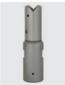
1/8" IG. Seitenstrahl 2. Vorstrahl 2. Rostfreier Edelstahl. Rotationskörper Hochdruckbronze. Kompakte Bauform, universell einsetzbar. Extrem hohe Reinigungsleistung, entfernt härteste Ablagerungen. 1 80 mm. Ø 12 mm. Gewicht 0,18 kg. Max. 1000 bar
