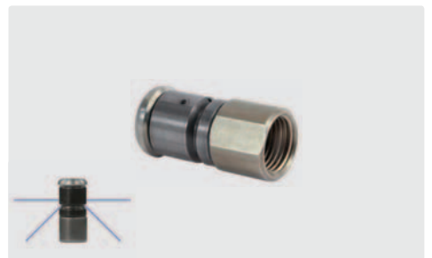
1/8" IG. Düse mit Zugwirkung. Rostfreier Edelstahl. Gehärteter Edelstahlrotationskörper. Kompakte Bauform, für universellen Einsatz. Extrem hohe Reinigungsleistung. Ø 12 mm. Max. 500 bar
