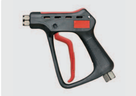
Professionelle Höchstdruckpistole. Max. 600 bar / 80 l/min / 150 °C
