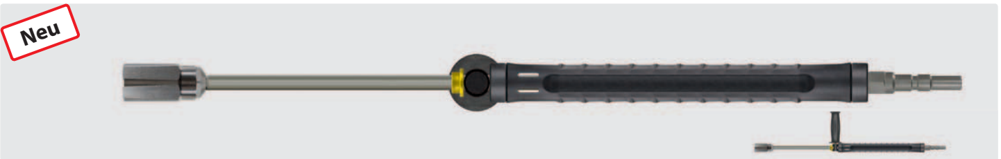
Stecknippel KW. Schaumlanze aus Edelstahl mit Luftinjektor, Isolierung ST-9.9 330 mm, Handgriff und Edelstahl Düsenmuffe mit Düse. Es wird ein Schauminjektor benötigt. Max. 250 bar / 80 °C
