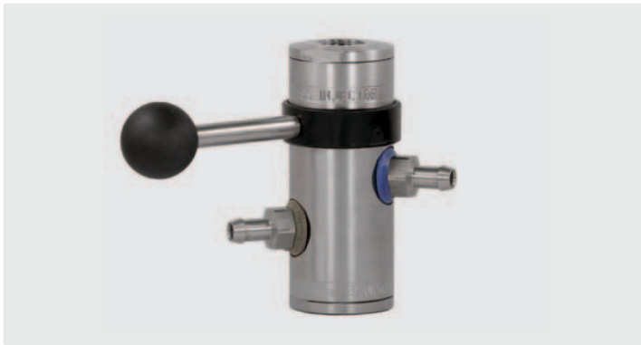
1/2" IG : 1/2" IG. Injektor mit Tülle 9 mm und Druckluftmodul (Tülle 9 mm). Regulierung der Chemiedosierung erfolgt durch 8 auswechselbare Dosiereinsätze (0,5 - 1,5 mm). Max. 350 bar / 100 °C
