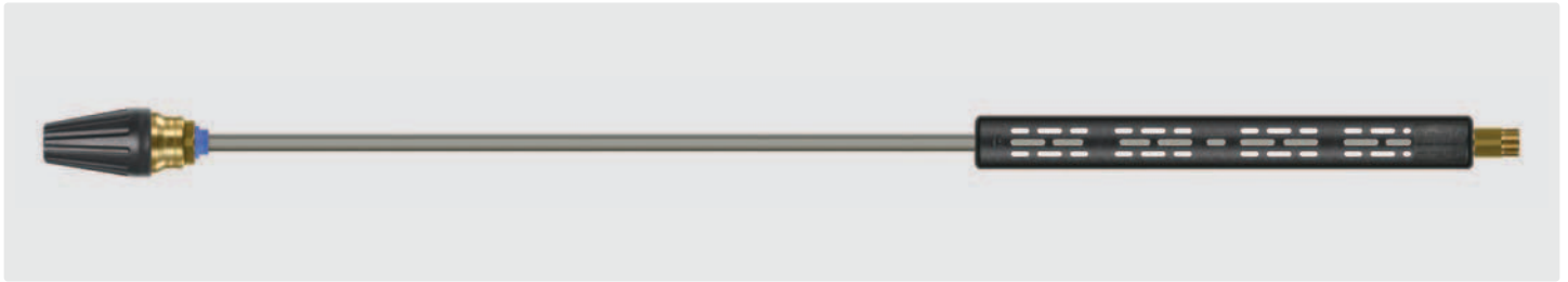
M22 AG. Strahlrohr mit Isolierung ST-9 380 mm und Rotordüse ST-458.1. Spritzwinkel 20°. 200 - 400 bar. Max. 100 °C
