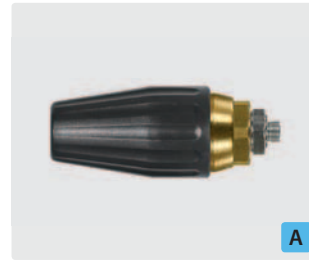
1/8" AG. Spritzwinkel 20°. 100 - 250 bar. Max. 100 °C
