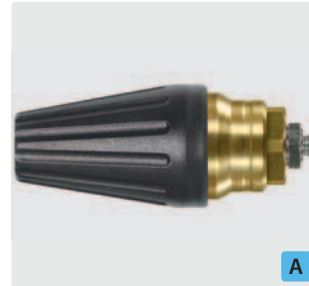
1/8" AG. Spritzwinkel 20°. 200 - 400 bar. Max. 100 °C
