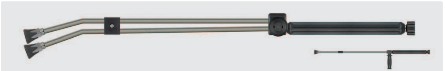
HV M22. Strahlrohr mit umspritzter Isolierung, Ventil ST-54 seitlich und Düsenschutz ST-10 mit Niederdruckdüse & Muffe 1/4" IG. Max. 310 bar / 150 °C
