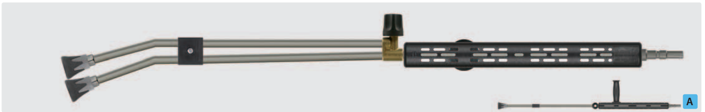
Stecknippel KW. Strahlrohr mit Isolierung ST-9 & Handgriff, Ventil ST-53 oben und Düsenschutz ST-10 mit Niederdruckdüse & Muffe 1/4" IG. Max. 250 bar / 150 °C
