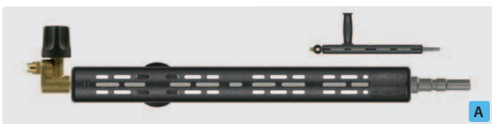
Stecknippel KW. Strahlrohr mit Isolierung ST-9 & Handgriff, Ventil ST-53 oben und Niederdruckdüse. Max. 250 bar / 150 °C
