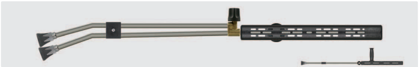
1/4" AG. Strahlrohr mit Isolierung ST-9 & Handgriff, Ventil ST-53 oben und Düsenschutz ST-10 mit Niederdruckdüse & Muffe 1/4" IG. Max. 250 bar / 150 °C
