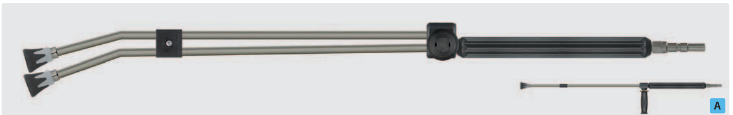
Stecknippel KW. Strahlrohr mit umspritzter Isolierung, Ventil ST-54 seitlich und Düsenschutz ST-10 mit Niederdruckdüse & Muffe 1/4" IG. Max. 310 bar / 150 °C
