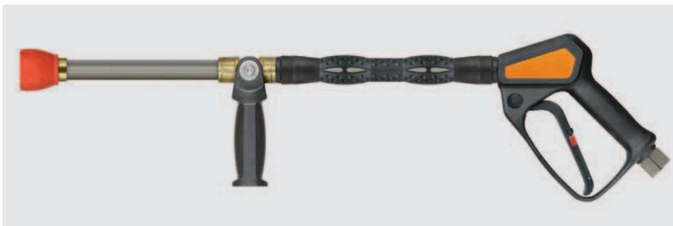
1/2" IG. Weitwurflanze 500 mm mit Isolierung ST-9.1 260 mm, Pistole ST-2320, seitlichem Handgriff und Düsenschutz aus Kunststoff ohne Düse. Max. 150 bar / 80 l/min
