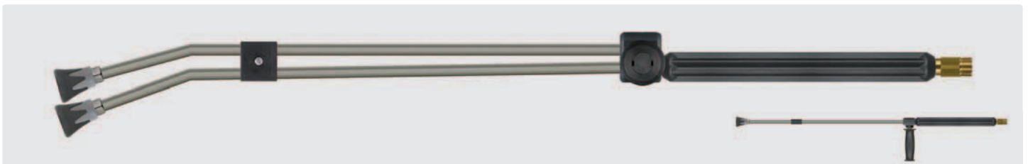
M22 AG. Strahlrohr mit umspritzter Isolierung, Ventil ST-54 seitlich und Düsenschutz ST-10 mit Niederdruckdüse & Muffe 1/4" IG. Max. 310 bar / 150 °C
