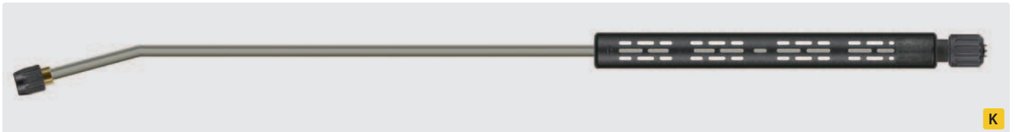
HV M22 drehbar. Strahlrohr mit Isolierung ST-9 und Düsenchutz ohne Mundstück. Max. 400 bar / 150 °C
