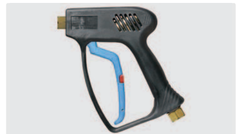
Professionelle Pistole. Frostschutzausführung. Max. 275 bar / 45 l/min / 150 °C
