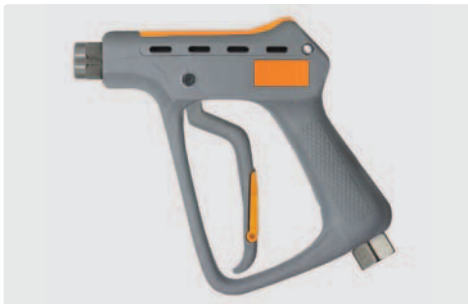
Professionelle High-Flow Pistole. Edelstahl. Industrielle Hochdruckreinigungs- und Spülpistole für den Bereich Kommunaltechnik, Kanalreinigung und Industrie. Ventilkolben aus gehärtetem Edelstahl. Max. 350 bar / 200 l/min / 150 °C
