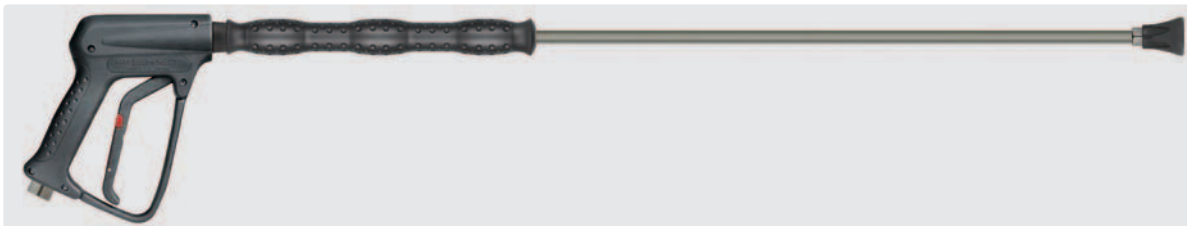
Professionelle Pistole R+M EcoLine No. ONE mit Strahlrohr 900 mm Stahl verzinkt, Isolierung ST-28 Cool & Compact 300 mm und Düsenschutz ST-10 ohne Düse. Max. 250 bar / 45 l/min / 150 °C
