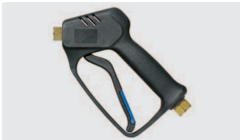
Professionelle Pistole. Weepausführung. Max. 210 bar / 25 l/min / 150 °C
