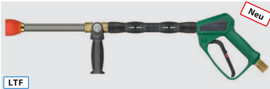
1/2" IG. Weitwurflanze 500 mm mit Isolierung ST-9.1 260 mm, easyfarm365+ Pistole, seitlichem Handgriff und Düsenschutz aus Kunststoff ohne Düse. Max. 180 bar / 60 l/min
