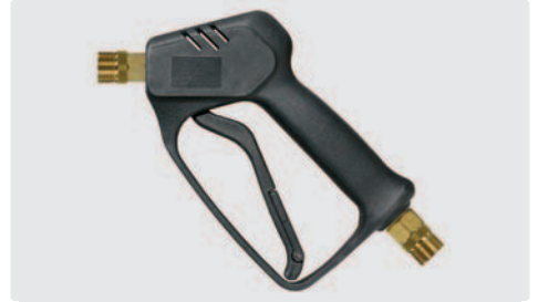
Professionelle Pistole. Max. 210 bar / 25 l/min / 150 °C
