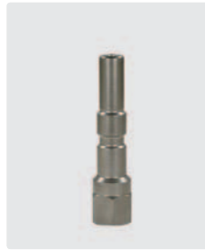
Stecknippel KW : 1/4" IG. Edelstahl poliert. SW 19. Für umspritzte Lanzen. Stecknippel für Aludichtscheiben
