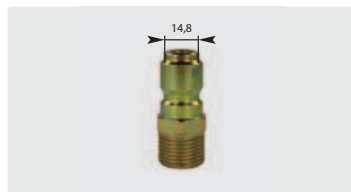
Stecknippel : AG. Ø 14,8 mm. Stahl verzinkt. Max. 150 bar / 100 °C
