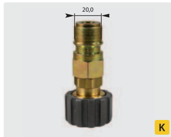
Stecknippel : IG. Stahl verzinkt + Messing. Max. 250 bar / 150 °C
