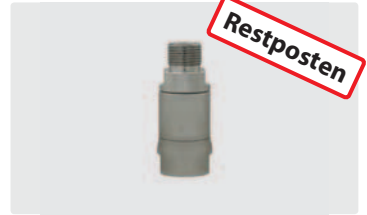
M14 AG : 1/4" IG. Messing vernickelt. Achse Edelstahl. 2-fach kugelgelagert. Max. 250 bar / 30 U/min / 120 °C
