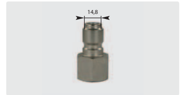
Stecknippel : IG. Ø 14,8 mm. Stahl verzinkt. Max. 150 bar / 100 °C
