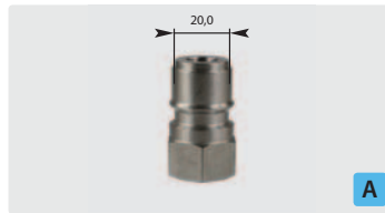
Stecknippel : IG. Edelstahl. Max. 250 bar / 150 °C
