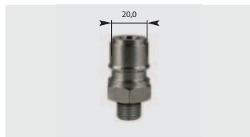
Stecknippel : AG. Edelstahl gehärtet. Max. 250 bar / 150 °C
