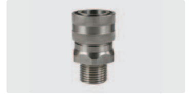
Kupplung : AG. Edelstahl. 60° Dichtkonus. Max. 250 bar / 150 °C
