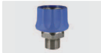
Kupplung : AG. Edelstahl. 60° Dichtkonus. Max. 250 bar / 150 °C
