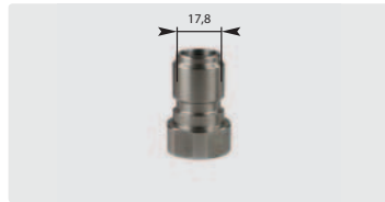
Stecknippel : IG. Edelstahl gehärtet. Max. 250 bar / 150 °C
