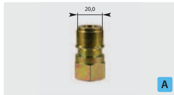
Stecknippel : IG. Stahl verzinkt. Max. 250 bar / 150 °C
