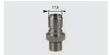
Stecknippel : AG. Edelstahl. 60° Dichtkonus. Max. 250 bar / 150 °C
