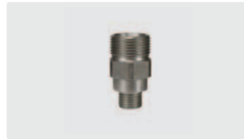
M22 AG : 1/4" AG. Langbohrung. Max. 400 bar / 150 °C
