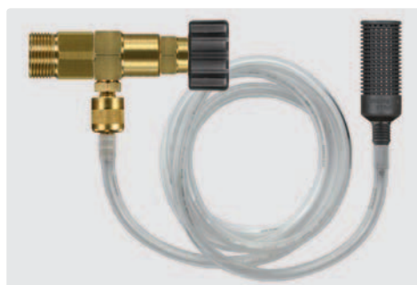
Injektor mit Dosierung, Saugschlauch 1000 mm und Ansaugfilter ST-31. Max. 220 bar / 90 °C
