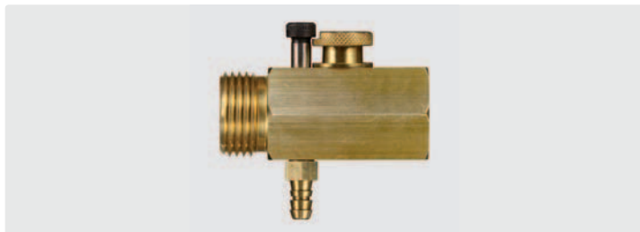
Injektor mit zu- und abschaltbarer Chemiedosierung. Zur Ansaugung von Chemie im Wassereingang der Pumpe. Chemie/Wassergemisch kann somit im Hochdruckbetrieb aufgetragen werden. Rückflussverhinderer (R+M Nr. 734 10 oder 734 20) verwenden. Tülle 6 mm. Max. 10 bar / 90 °C
