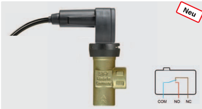
1/4" AG. Schutzklasse IP65. Kabel 1200 mm. 10 A. 250 V. Einschaltstrom 20 A (Öffner) und 15 A (Schließer). Max. 350 bar / 45 l/min / 80 °C
