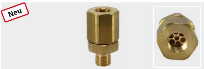
Messing mit Edelstahlsieb. Bidirektional einsetzbar. Max. 400 bar / 40 l/min. / 150 °C
