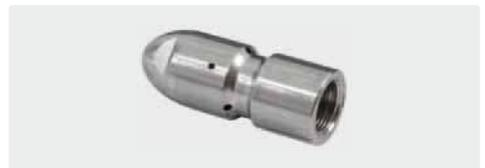
M7 IG. 3 Bohrungen nach hinten für optimalen Vortrieb. Zusätzlich 3 seitliche Bohrungen (90°) für hohe Aufprallkräfte und optimale Wandabdeckung. Außen  $\varnothing$  9,8 mm.
