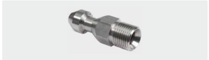
Rohrreinigungsdüse für Standard-Anwendungen. 4 Bohrungen hinten (30°) für gute Zugwirkung.
