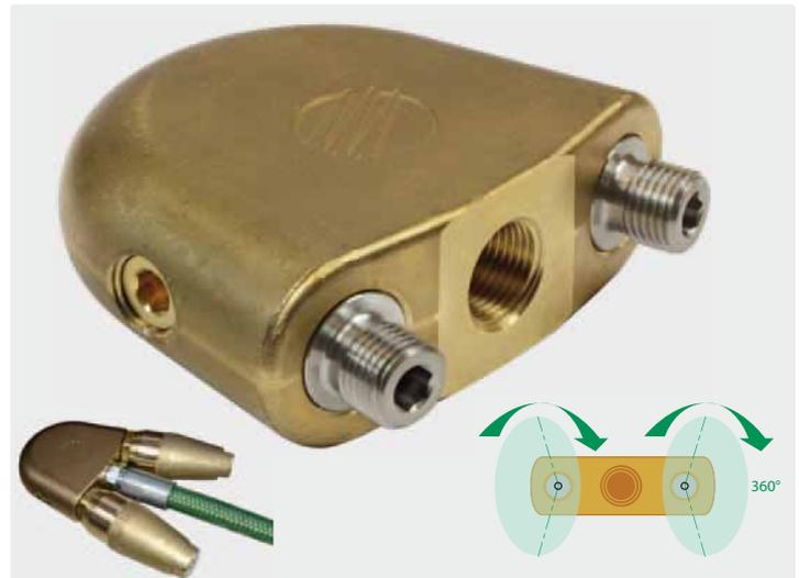
Als Träger für 2 Rotordüsen ST-357. Die Flunderdüse ist die ideale Lösung für das Freispülen von festsetzenden Ablagerungen. Durch die rotierenden Strahlen wird die Spülwirkung bei unter Wasser stehenden Rohrleitungen vervielfacht. Die schwere, geschmiedete Messingausführung hält den Strahl in der Nähe der Schmutzansammlungen am Boden und befördert diese zur Einstiegsöffnung.
