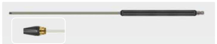
Stecknippel ST-3100. Strahlrohr aus Edelstahl, umspritzte Isolierung 400 mm und 1/4" AG Anschluss für Rotordüsen. Strahlrohre werden ohne Rotordüsen geliefert. Max. 400 bar / 150 °C
