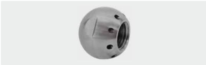
8 Bohrungen 0,6 mm nach hinten für maximalen Vortrieb und ideale seitliche Abdeckung der Rohrwandflächen. Besonders geeignet für öl- und fetthaltige Verschmutzungen sowie Wurzeleinwuchs. Komplette kugelförmige Düsenbohrungen vertieft für optimalen Schutz gegen mechanische Beanspruchung.
