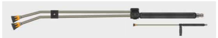
Stecknippel ST-3100. Strahlrohr aus Edelstahl, umspritzte Isolierung 300 mm, Ventil ST-54 seitlich und Düsenschutz ST-10 mit Niederdruckdüse und Muffe 1/4" IG. Max. 310 bar / 150 °C
