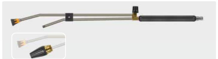
Stecknippel ST-3100. Strahlrohr aus Edelstahl, umspritzte Isolierung 300 mm, Ventil ST-53 oben, Düsenschutz ST-10 mit Niederdruckdüse und 1/4" AG Anschluss für Rotordüsen. Strahlrohre werden ohne Rotordüsen geliefert. Max. 250 bar / 150 °C
