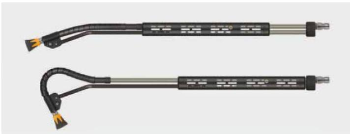
Stecknippel ST-3100. Strahlrohr aus Edelstahl, Isolierung ST-9 380 mm und Düsenschutz ST-10 ohne Düse. Stufenlose Verstellung des Biegewinkels der Lanze von 20 - 140°. Sie erreichen jeden Winkel ohne Verrenkungen und mühelos. Max. 210 bar / 150 °C
