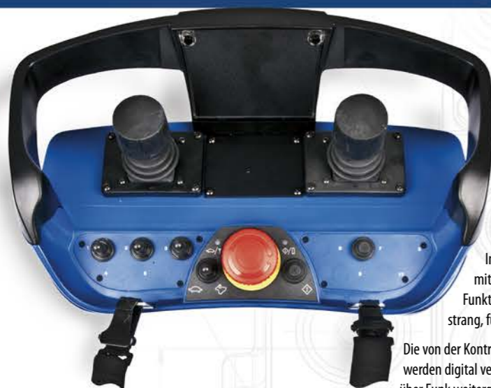
3 Achsen-Joysticks mit 6 Funktionen
